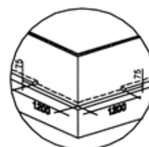
spouwisolatie in de hoek over 1200 mm doorgezet
