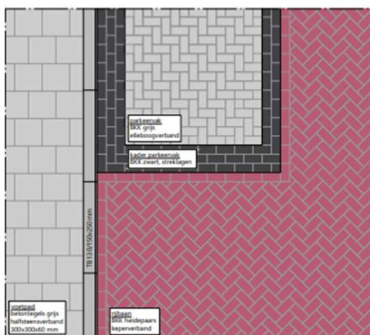
PRINCIPEDETAIL LANGSPARKEREN (KLINKERS) SCHAAL 1:20
