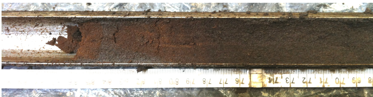
Boring 1: top dekzand
